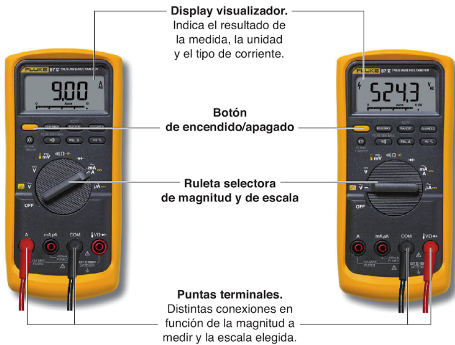
↑ Figura 3.8. Conexionado de un multímetro digital para la medida de intensidad y para la medida de tensión (FLUKE).
